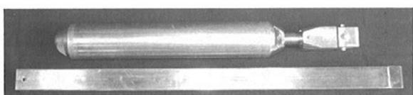
写真9 GeoCom 定方位サンプラーシステム
