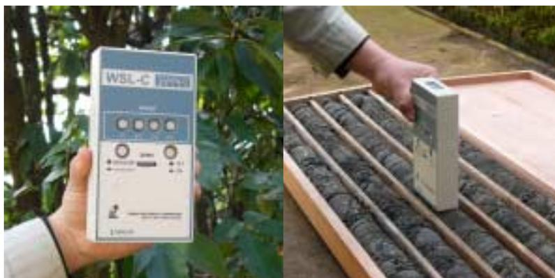
写真—1 ポケット型帯磁率計 WSL-C（帯磁率の測定状況）
